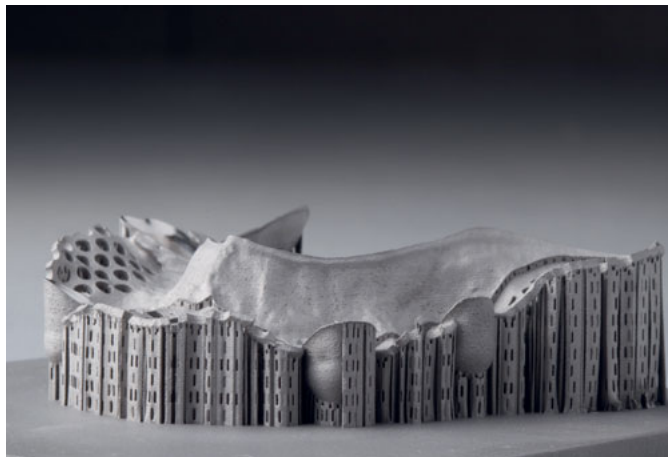
Abb. 2 Einstückstruktur nach der SLM-Fertigung und dem Feinfräsen auf der Bauplatte.
