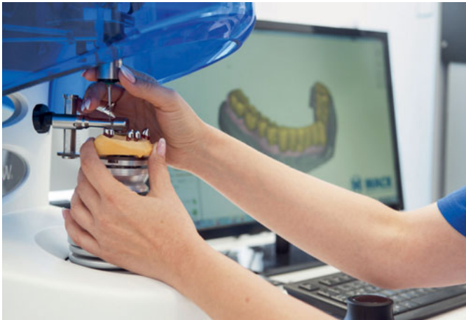
Abb. 13 Digitalisieren der Primärteile mit einem taktilen Scanner.
