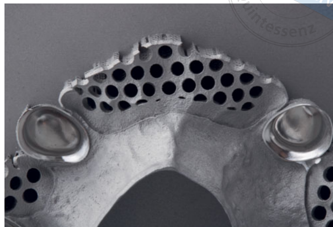
Abb. 18 Einstückstruktur mit voreingepasstem Primärteil direkt nach dem Herstellen im Hybridverfahren (Auslieferungszustand).
