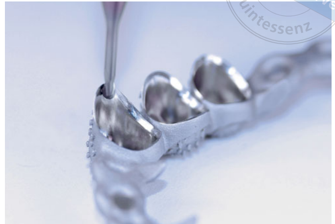
Abb. 1 Einstückstruktur aus NEM im Hybridverfahren aus SLM- und Frästechnologie. Hier: Feinfräsen der Sekundärstruktur.
